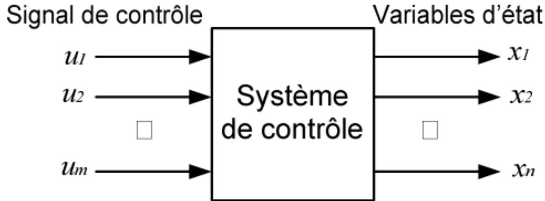
Le système de contrôle que nous considérerons est montré sur la figure et peut être représenté par l'équation différentielle suivante:  $\dot{x} = Ax + Bu$
