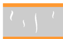
Fissure perpendiculaire, dans un élastomère
