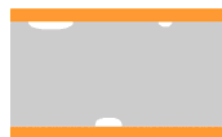
Mauvaise adhérence de l'isolant sur les électrodes
