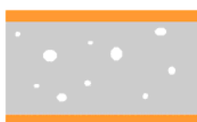
Cavités dans la résine époxy par exemple
