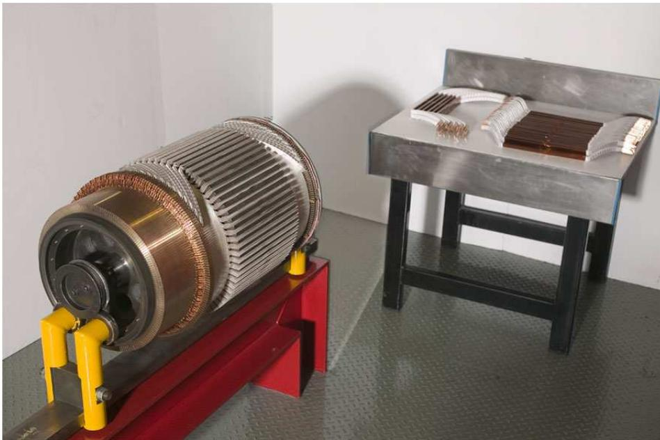
FIGURE 3.8 – Mise en place des conducteurs d'induit dans les encoche et sou-
