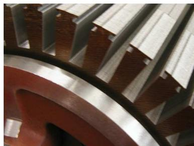
FIGURE 3.6 – Encoche sur l'induit destinée à recevoir les conducteurs dits actifs.
