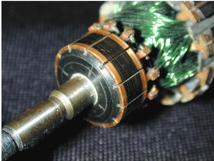
FIGURE 3.11 – Collecteur d'une machine à courant continu de faible puissance.
