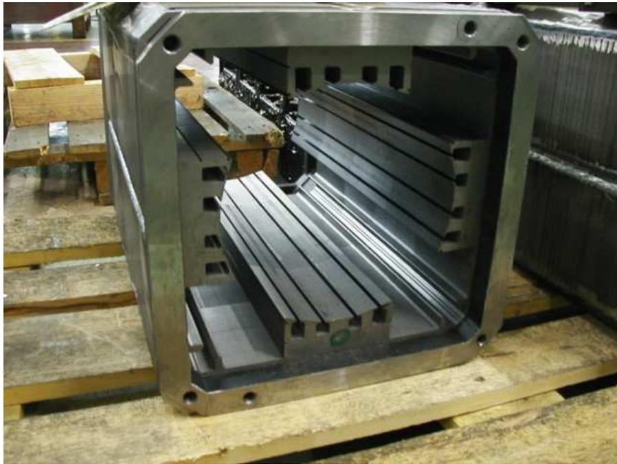
FIGURE 3.3 – Culasse, circuit magnétique statorique d'une machine à courant continu.
