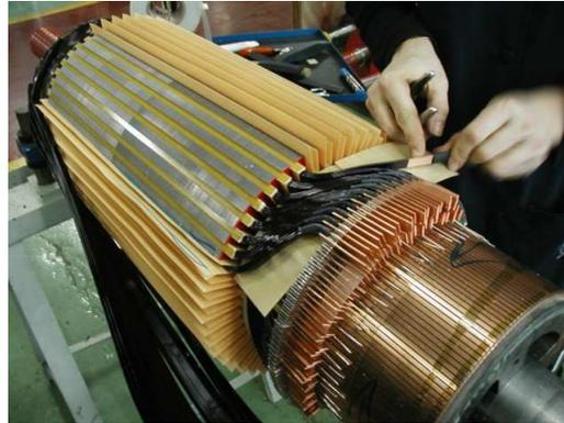
FIGURE 3.7 – Mise en place des conducteurs d'induit dans les encoche et sou-
