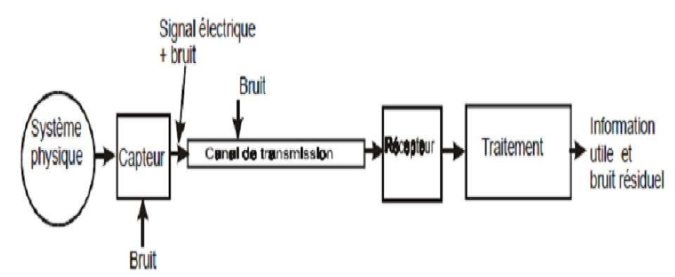
Chaine de transmission d'un signal analogique.
