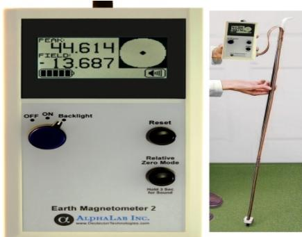
فإن شدة المجال المغناطيسي على سطح الأرض تتغير باختلاف عمق الصخور القاعدية (الصخور النارية) فتزداد شدة المجال المغناطيسي للأماكن التي تقل فيها المسافة بين سطح الأرض وتلك الصخور. تفاصيل جهاز يسمى ال Magnetomètre
