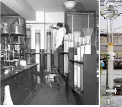
يعتمد هذا النوع من الكروماتوغرافيا على نفس مبدأ TLC، باستثناء أن السيليكا توضع في عمود وليس على لوحة. لكن الهدف مختلف: يستخدم العمود اللوني لفصل المنتجات، أو لتنقية منتج التفاعل. هذه هي الطريقة القياسية لتنقية في مختبر الكيمياء العضوية. إنها طريقة تحضيرية، يمكنها تنقية 50mg إلى حوالي 20 g في المختبر، وما يصل إلى 1 kg في الصناعة. يتم اختيار المذيب عن طريق تجربة عدة مذيبات بحيث
