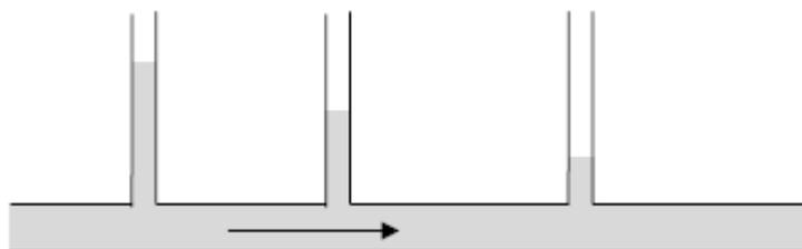
Les pertes de charge sont un élément fondamental de l'écoulement des liquides car elles apparaissent pour tous les liquides. Elles se classent en deux types:
