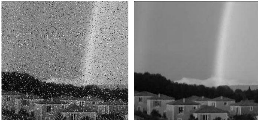
Figure 2.31 : A gauche image bruitée par un bruit poivre et sel (10%) et à droite image filtrée deux fois par un filtre médian 3x3.
