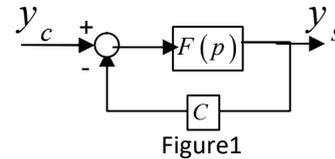
La grandeur à asservir est désormais mesurée par un capteur (de gain C) avant d'être envoyée dans le comparateur.
