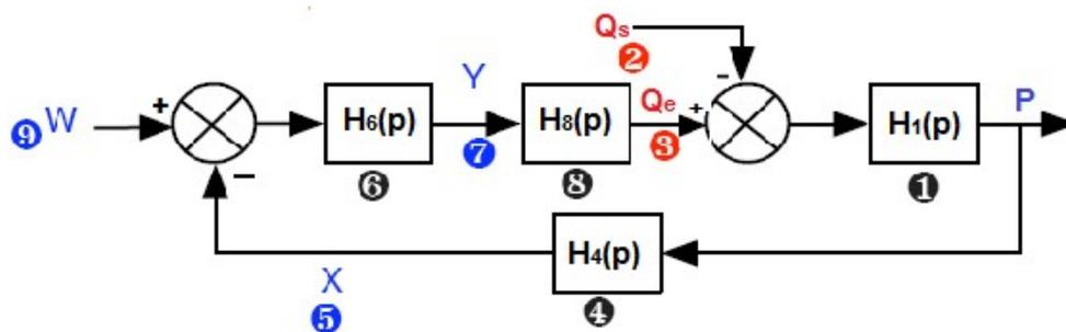
$H_1(p)$ : FT du bac.,  $H_4(p)$  : FT du transmetteur,  $H_6(p)$ : FT du correcteur, et  $H_1(p)$ : FT de la vanne.
