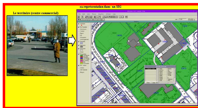
Figure IX.1 – La représentation de la réalité dans un système d’information géographique
