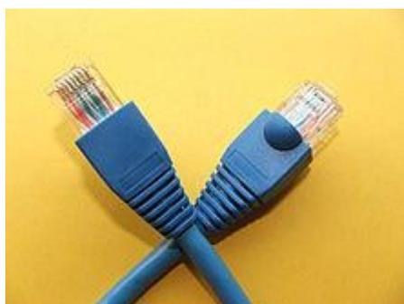
*Fig. Connecteurs RJ 45*
