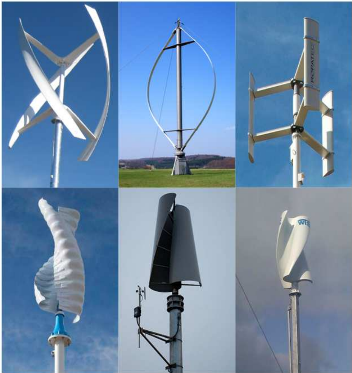
Figure 3.5: Les différents types d'éoliennes de type Darrieus et Savonius
