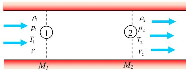
**Fig. II-3 :** Écoulement dans une conduite.
