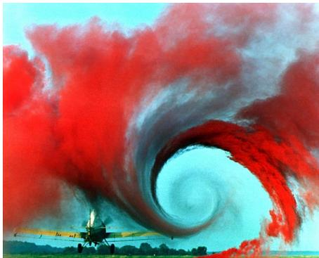
**Image de couverture** : Un vortex créé par le passage d'une aile d'avion, révélée par la fumée, (4/5/1990).
