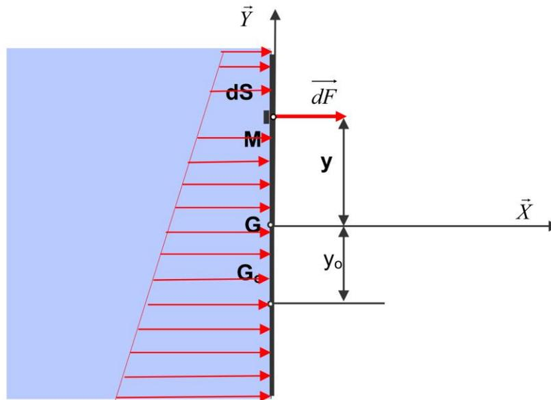
Connaissant la pression  $P_G$  au point G, la pression  $P_M$  au point M est déterminée en appliquant la relation fondamentale de l'hydrostatique :  $P_M - P_G = \varpi.(Y_G - Y_M)$
