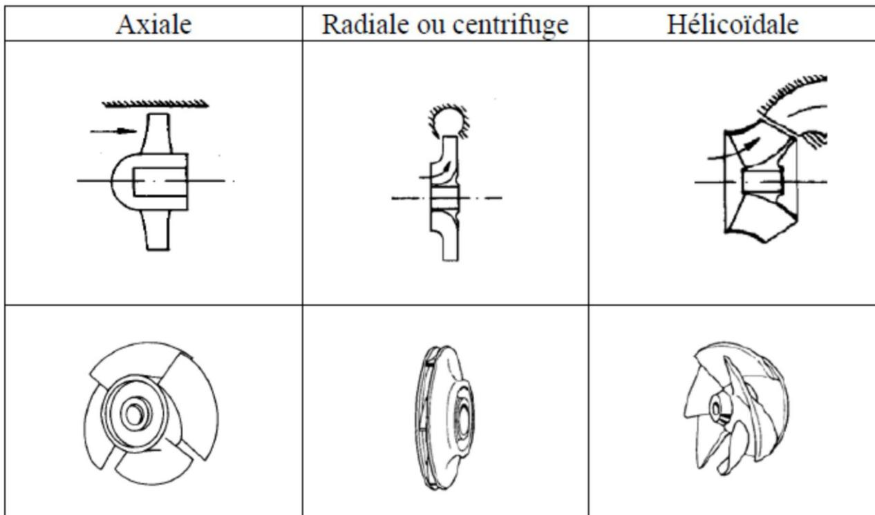
Figure trajets du fluide dans une turbomachine.
