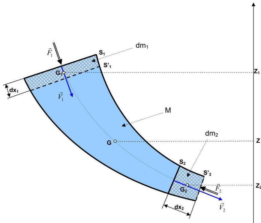
Par conservation de la masse :  $dm_1 = dm_2 = dm$  et puisque le fluide est incompressible :  $\rho_1 = \rho_2 = \rho$ , On aboutie à l'équation de Bernoulli :
