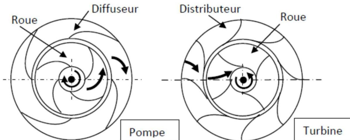
**Figure** Eléments constitutifs des turbomachines
