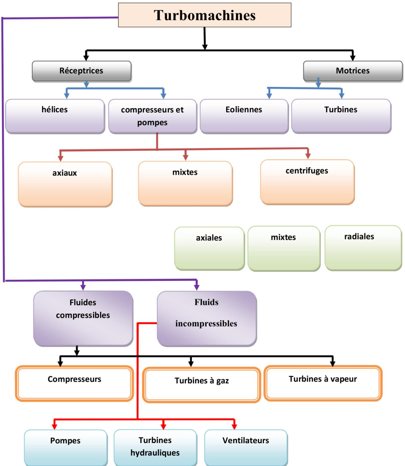
Figure classification générale des turbomachines.
