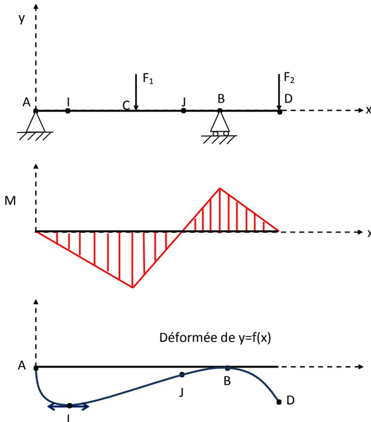
Pour la poutre ci-dessus, la ligne moyenne AICJBD a pour direction l'axe des  $x$  avant déformation et la courbe  $y = f(x)$  après déformation. Cette courbe est appelée déformée.  $y = f(x)$  est l'équation mathématique de la déformée dans le système d'axes  $(x, y)$ .
