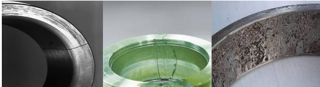
Figure I. 12. Fissure (cassure) et piquetage dans la bague extérieure.
