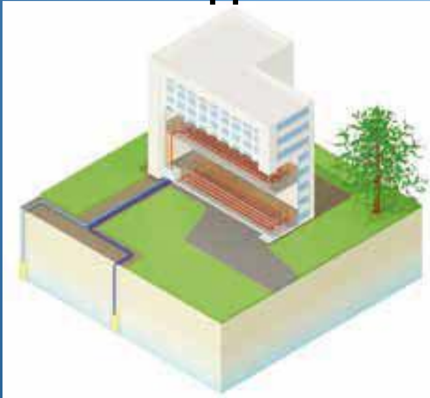
PAC géothermique sur nappe
