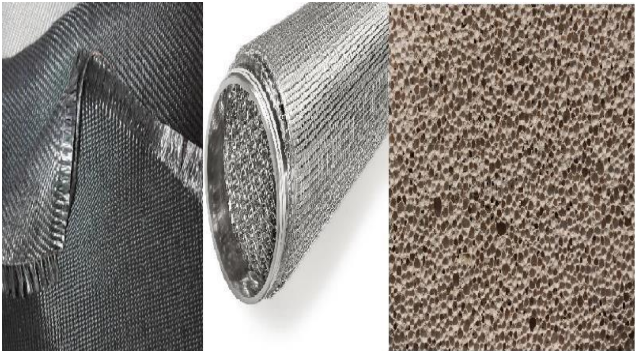
Figure IV.3 : Types de filtres employés dans la filtration des eaux
