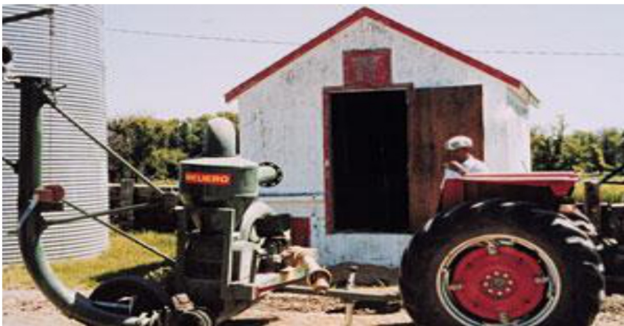
Figure 39 : Exemple d'aspirateur à grain attaché à un tracteur
