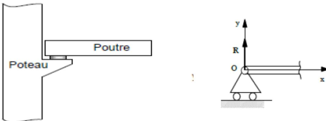
$R_y$  : réaction d'appui suivant l'axe y
