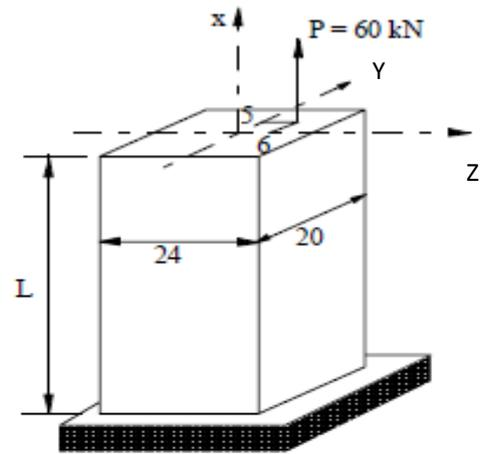
2- La force inclinée par rapport à l'axe moyen de la poutre provoque une flexion composée dont les moments et l'effort normal résultant des projections de la force sur les axes y-y, z-z et x-x sont respectivement:
