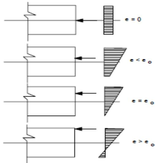
Le contour du noyau central de la section est déterminé par l'ensemble des positions des points d'application de la force excentrée qui fait passer l'axe par tous les points tangents à la section de telle manière qu'elle ne le coupe nulle part.
