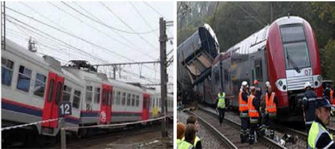
Figure 13 : Exemple de collision par rattrapage.
