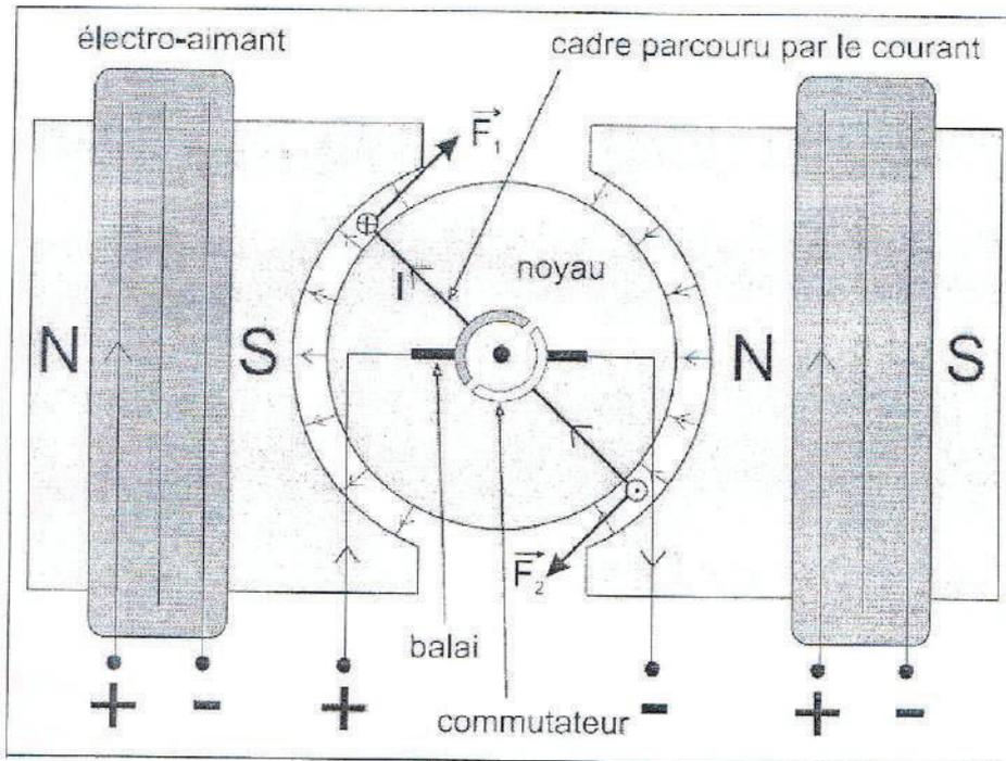
Figure I.8 : Exemple d'application de la force de Laplace dans une machine CC
