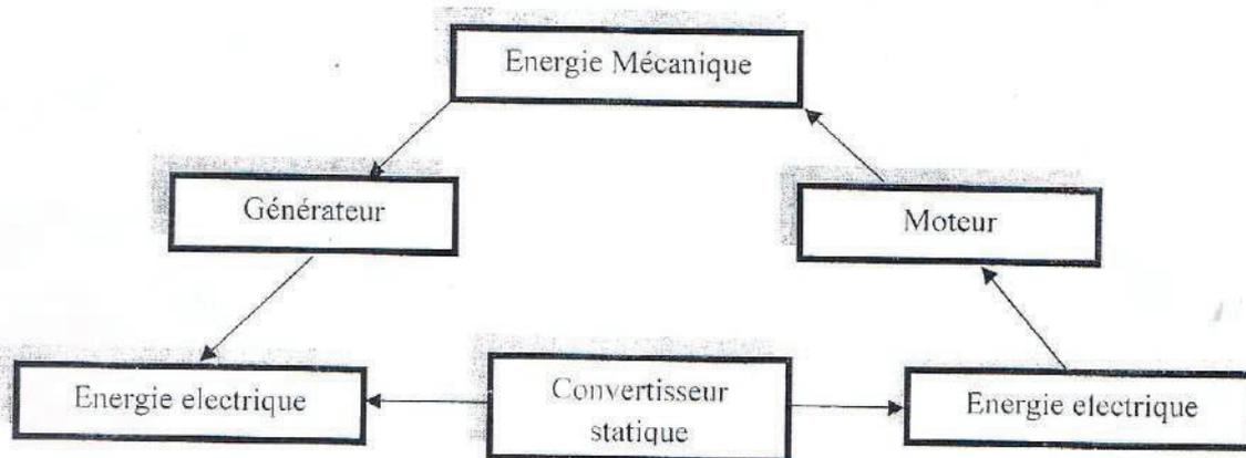
Figure I.1 : La conversion d'énergie par les machines électriques.
