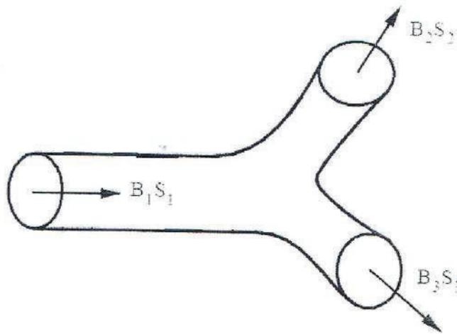
Figure I.5 : Tube de flux avec embranchements
