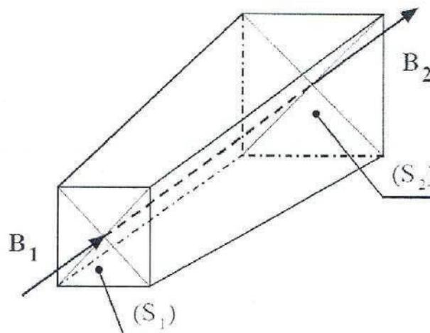
Figure I.5 : Tube de flux
