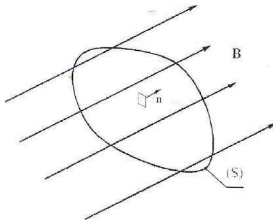
Figure I.4 : Flux au travers d'une surface quelconque
