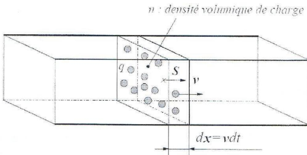
Figure I.7 : Déplacement de charge dans un conducteur
