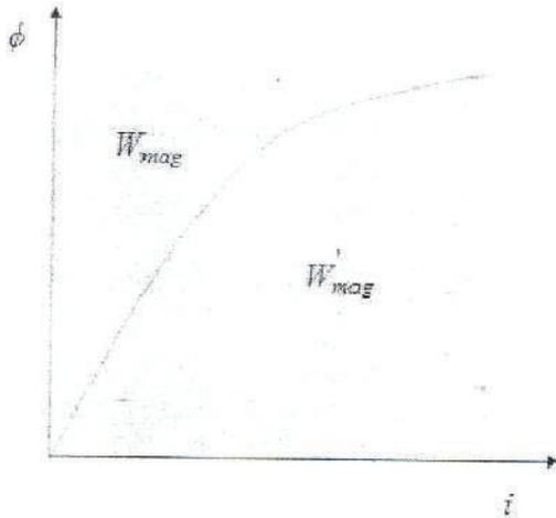
Figure I.9 : Énergie magnétique et co-énergie dans un système non-linéaire.
