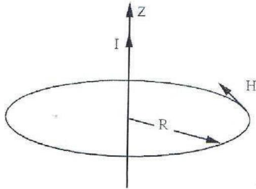
Figure I.3 : Champ magnétique créé par un courant circulant dans un conducteur de longueur infinie.
