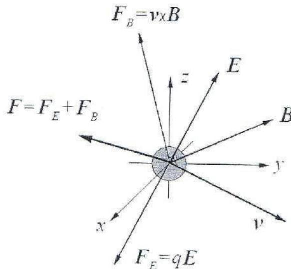
Figure I.6 : Forces appliquées à une charge en mouvement dans un milieu électromagnétique
