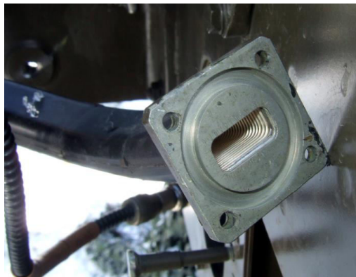
Figure II.14 Guide d'onde métallique.
