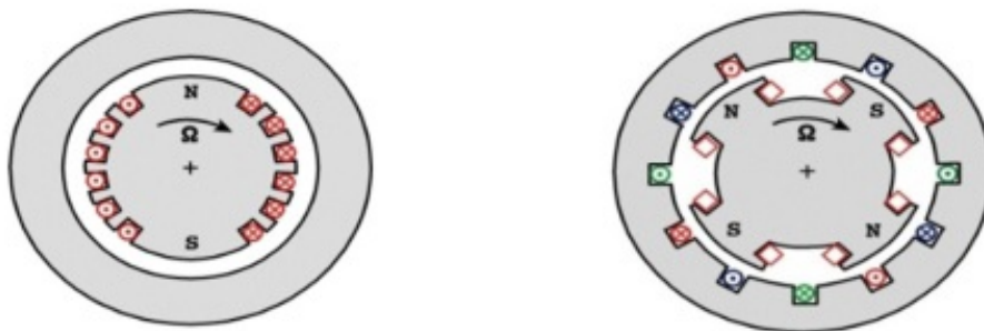
Figure 1: (a) Rotor à pôles lisses (b) Rotor à pôles saillants
