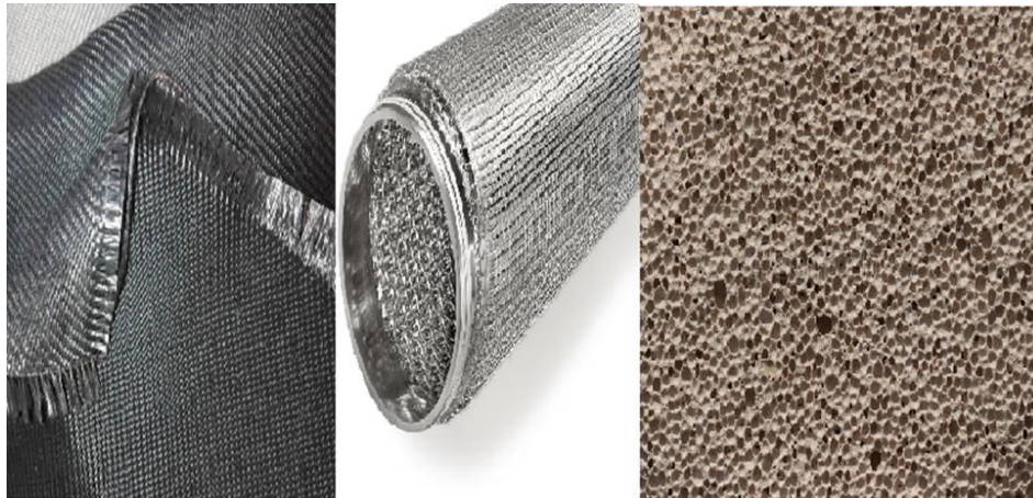
Figure IV.6 : Types de filtres utilisés dans le traitement des eaux
