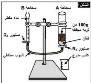
**4- الاحتفاظ بالماء والسعة الحقلية:** نحضر التركيب التجريبي المبين في الوثيقة الآتية حيث نسجل حجم الماء الذي يمرر إلى التربة (ح1) وحجم الماء الذي يجمع في الكأس والمتسرب من التربة (ح2) حيث ان قدرة الاحتفاظ بالماء هي كمية المتبقي في التربة (ح2 - ح1). وهو السعة الحقلية كما يعبر عنها بالنسبة المئوية للوزن التربة الجافة .
