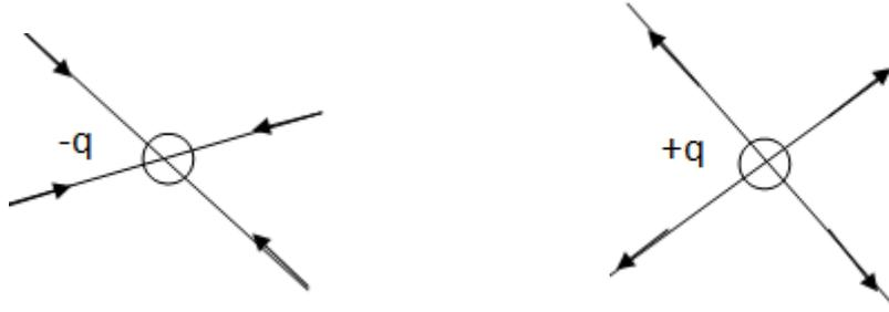
الكمون الكهربائي الناتج عن شحنة نقطية.
