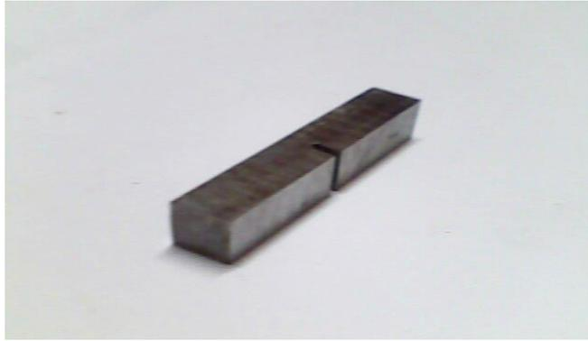
Figure 3. Eprouvette de résilience utilisée
