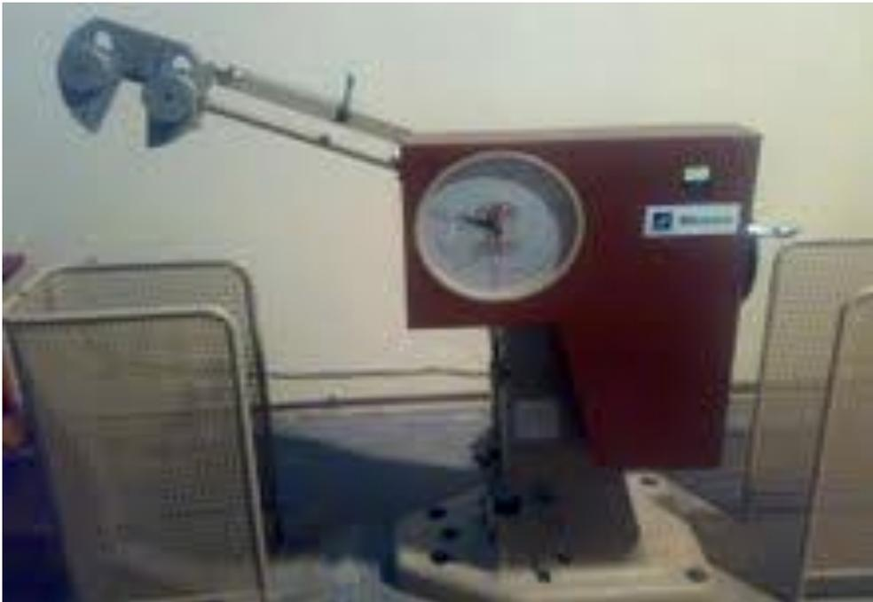
Figure 4. Machine utilisée pour les essais de résilience
