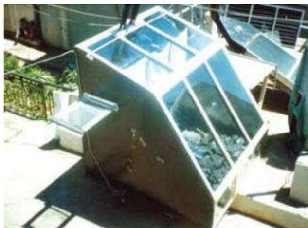
**Figure:** Séchoir solaire serre
