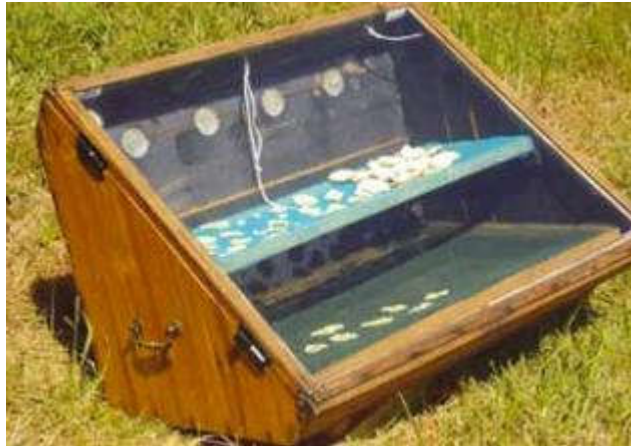
Figure : Séchoir solaire direct portatif
