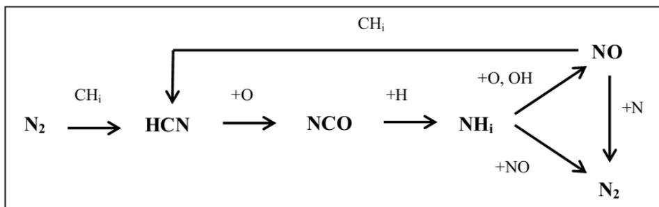
Les niveaux typiques de NO-précoce formé sont de l'ordre de quelques ppm à plusieurs centaines de ppm suivant les conditions expérimentales. Dans une flamme riche en combustible et présentant une température inférieure à 2000 K, ce mécanisme est la principale source d'oxydes d'azote. Le mécanisme du NO précoce est très sensible à la richesse du mélange réactif, ainsi qu'à la nature de l'hydrocarbure.
