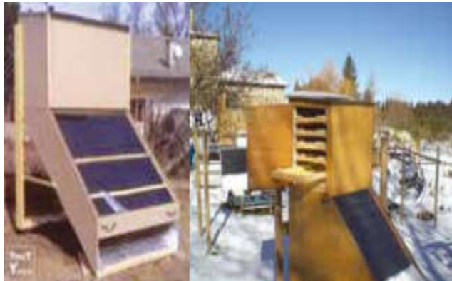
Figure 23 : Deux types de séchoirs solaires indirects
