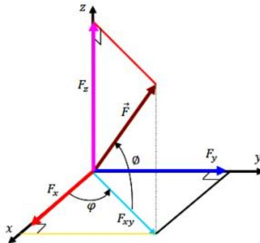
Fig.II.9. deux angles qui orientent la ligne d'action sont connues:
