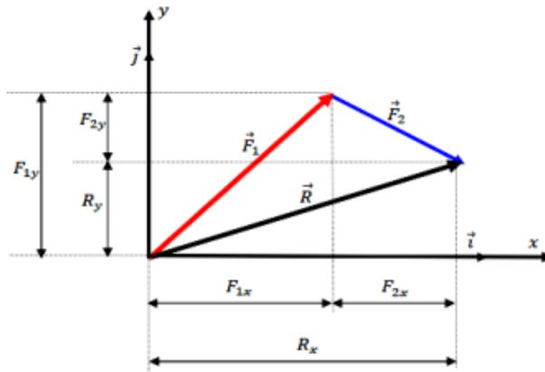
**Fig. II.6.** résultante de deux forces concourantes coplanaires
