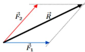
**Fig. II. 2b.** Parallélogramme des forces
