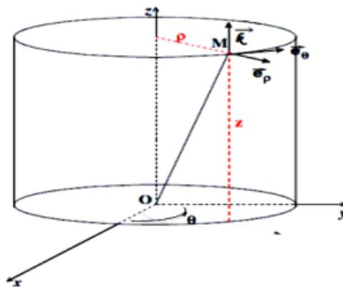
**Fig. I.4.** Les coordonnées cylindriques
