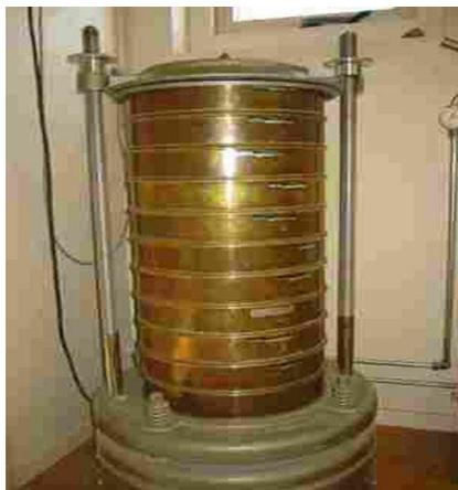
Figure 2.7 : Un jeu de tamis pour un test en laboratoire
