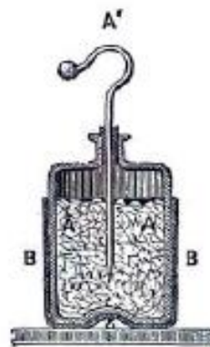
FIG. 142. — Bouteille de Leyde. — A, armature intérieure; B, armature extérieure.
