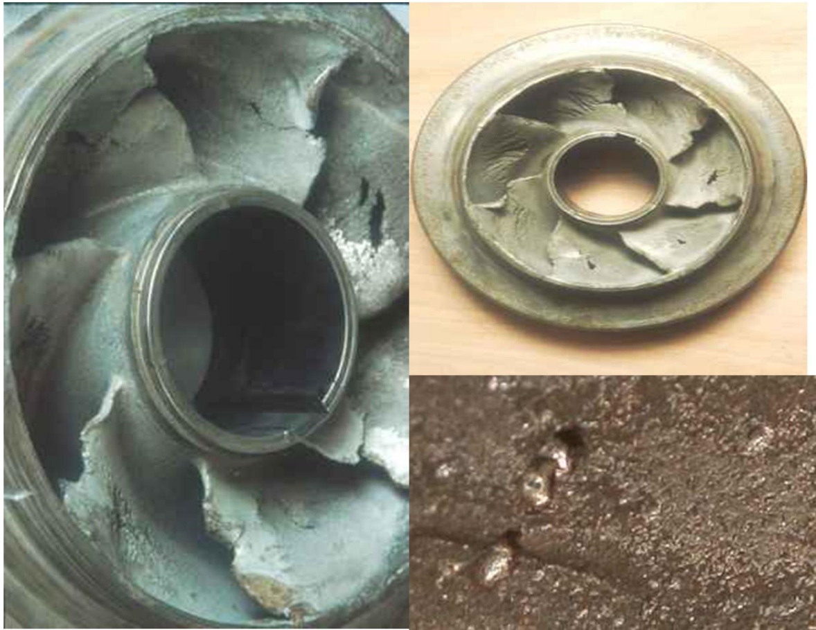
Figure 2.17 Conséquences de cavitation : Piqûres et endommagements
