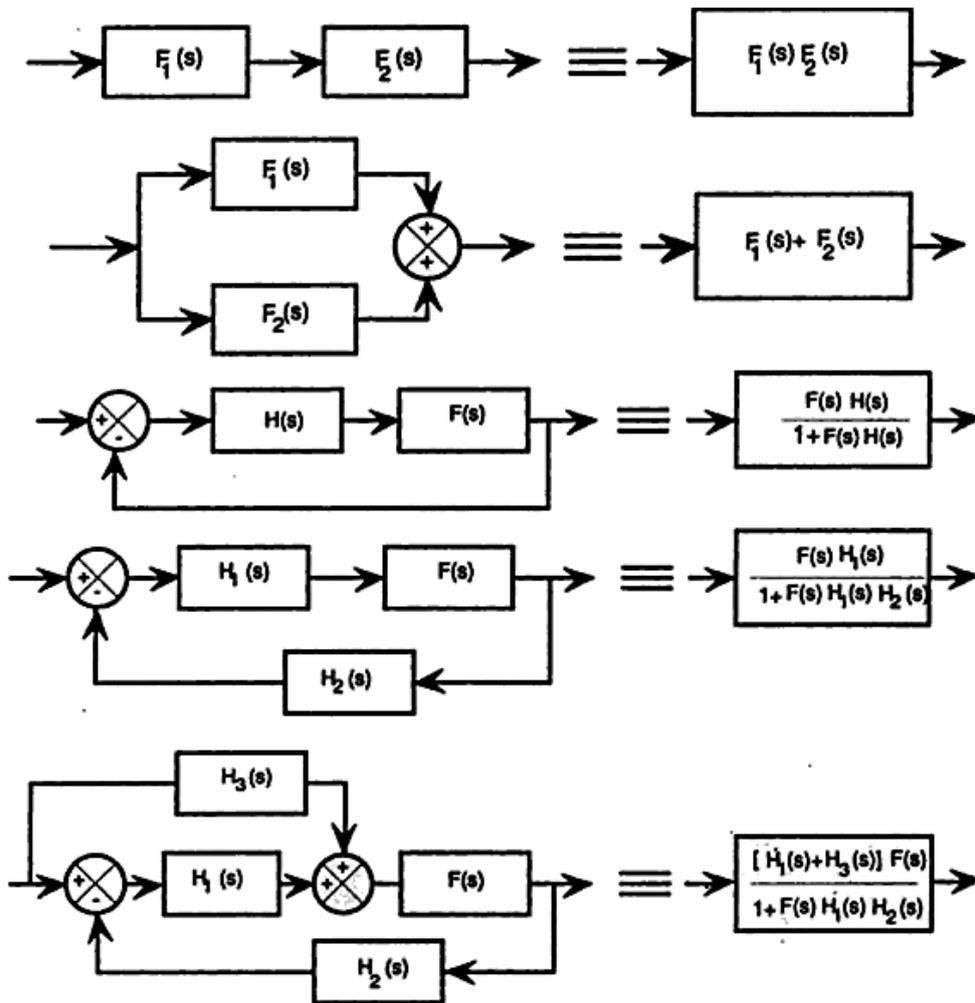
Figure 5 Composition des fonctions de transfert.
