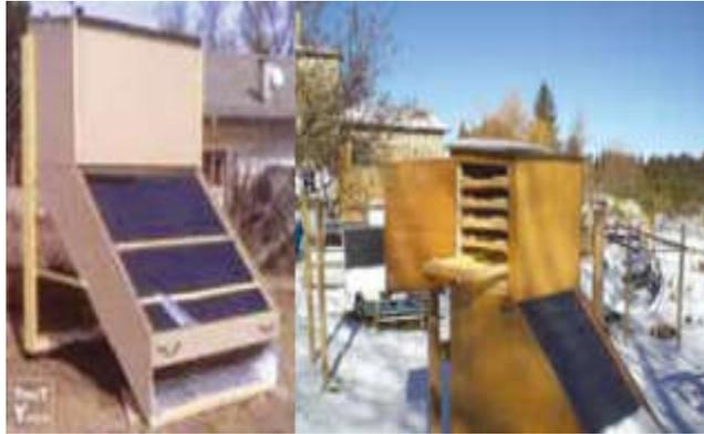
**Figure 23** : Deux types de séchoirs solaires indirects
