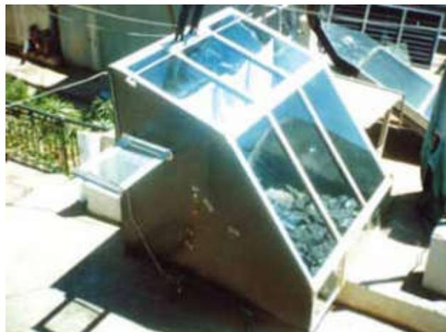
**Figure 22 : Séchoir solaire serre**
