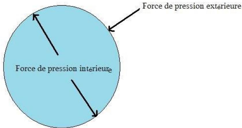
Fig. : Les deux forces exercées sur le volume connexe
