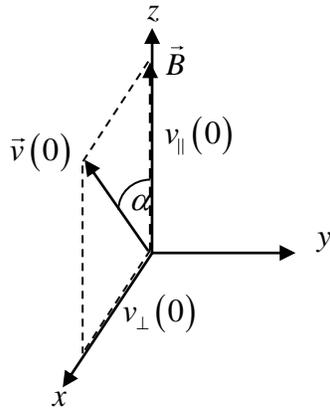
الشكل 2: يبين وضع الحقل المغناطيسي الثابت  $\vec{B}$ ، وسرعة الشحنة  $q$  عند الابتداء  $\vec{v}(0)$  ومركباتها
