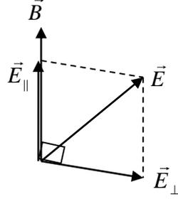
الشكل 9: يبين عدم تعامد الحقل الكهربائي مع الحقل المغناطيسي، ومركبات الحقل الكهربائي
