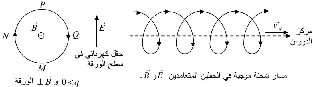
حركة  $q$  في وجود حقل كهربائي، يجرفها بالسرعة  $\vec{v}_d$
