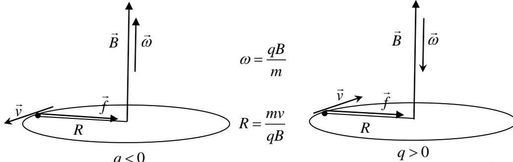
الشكل 1: يبين حركة شحنة موجبة في حقل  $B$  ثابت الشكل 1 ب: يبين حركة شحنة سالبة في حقل  $B$  ثابت
