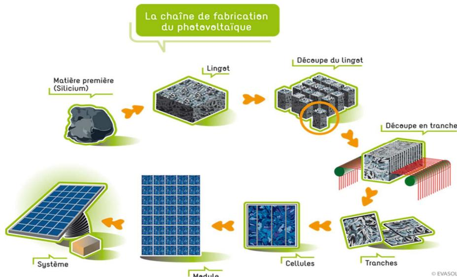
Figure 2.7: La chaîne de fabrication du photovoltaïque
